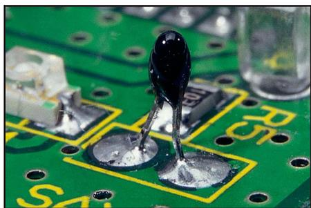
**Bild 5: Sensor zur Temperaturmessung**
